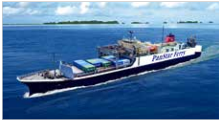
PANSTAR GENIE NO.2 - Gross Ton : 13,681M/T - L.O.A : 161.13M - Speed : 18.00kn - Cargo Capacity : 264TEU
