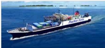
PANSTAR GENIE NO.2 - Gross Ton : 13,681M/T - L.O.A : 161.13M - Speed : 18.00kn - Cargo Capacity : 264TEU
