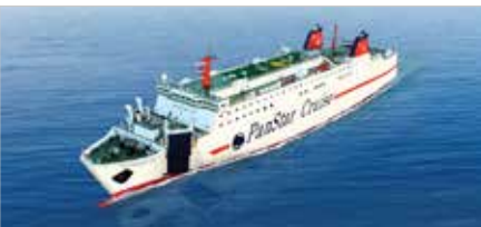
PANSTAR DREAM - Gross Ton : 21,688M/T - L.O.A : 160.00M - Speed : 22.70kn - Cargo Capacity : 184TEU
